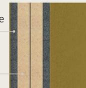
2 panneaux de particules forte densité épaisseur 10 mm, 2 épaisseurs de mousse de Mélangine 5 mm collées de chaque côté, soit 10 mm. Le tout recouvert de Tissu (au choix).
