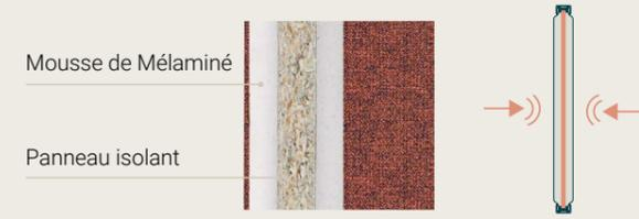
1 panneau de particules forte densité épaisseur 10 mm, 2 épaisseurs de mousse de Méla miné 8 mm, collées de chaque côté, soit 16 mm le tout recouvert de Tissu au choix. Test réalisé par le FCBA N° 04 / PC / PHY / 3009-2 du 10 mars 2004.
